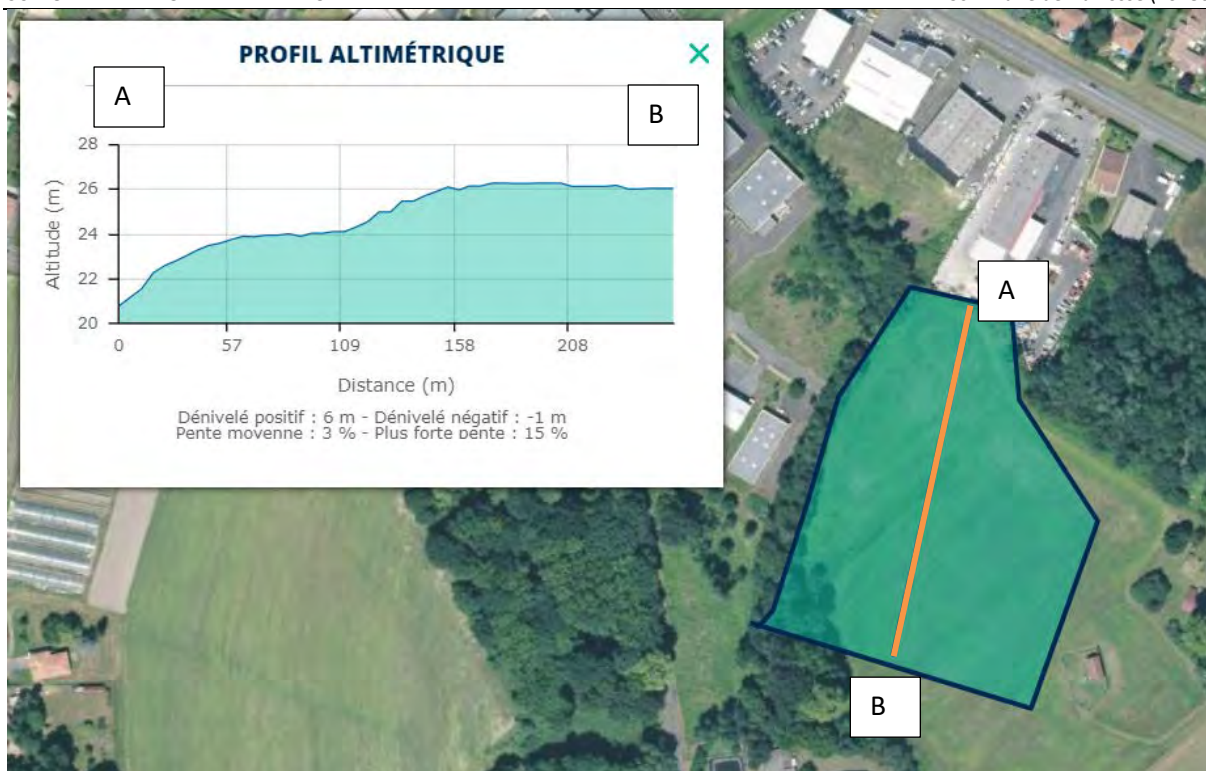
Figure 12 : Topographie du site : Tronçon N/OS (Source : Géoportail)
