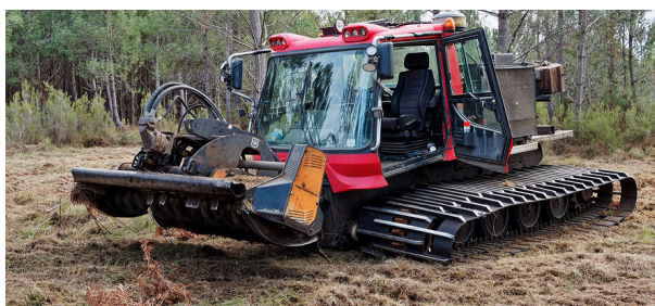
Dameuse modifiée pour l'entretien mécanique de la végétation basse en marais
