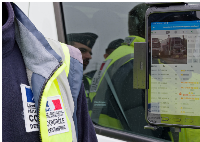
Système d'interrogation à distance des chronotachygraphes numériques lors d'un contrôle routier
