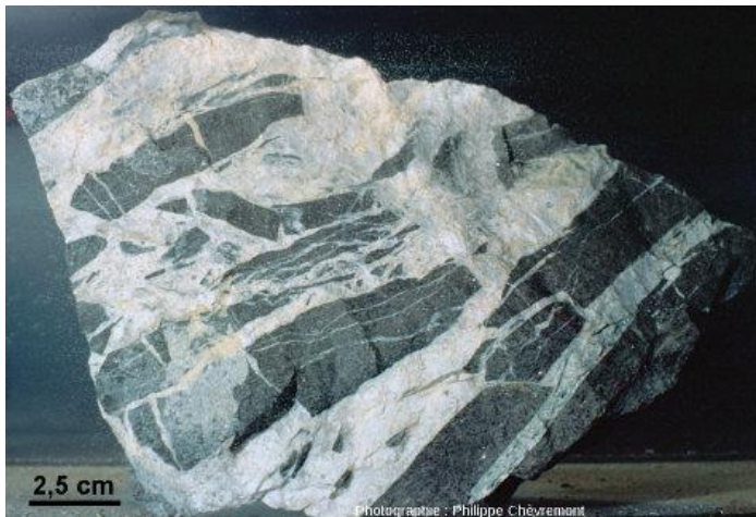
Figure 19 : Exemple d'une brèche hydrothermale à éléments de lamprophyre et ciment de quartz (source P. Chèvremont)
