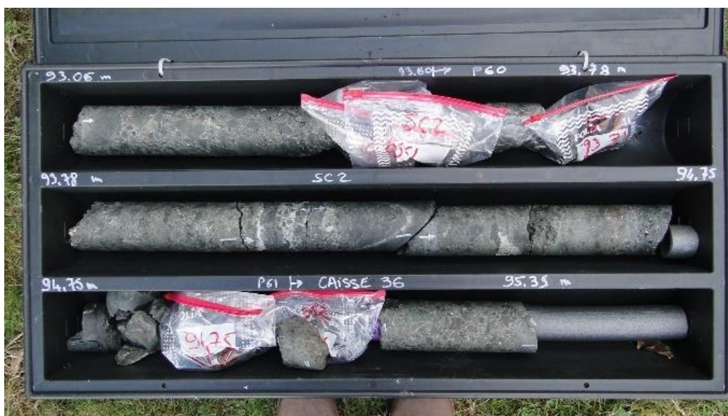
Figure 27 : Exemple d'une caisse avec carottes (forage SC2).
