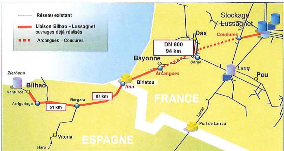
Schéma de principe du projet – extrait de dossier de mise en compatibilité
