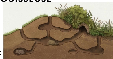
Terrier dans digue
