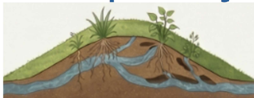
Erosion interne et renards hydrauliques
