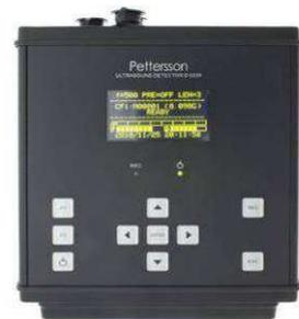
Le détecteur enregistre automatiquement les émissions sonores situées dans la gamme de fréquence des chiroptères. Les séquences sont sauvegardées sur carte mémoire pour être écoutées ultérieurement en mode expansion de temps et faire l'objet d'analyses informatiques. Cette technique présente l'avantage de faciliter la récolte de nombreuses données, mais sur un nombre réduit de points.
