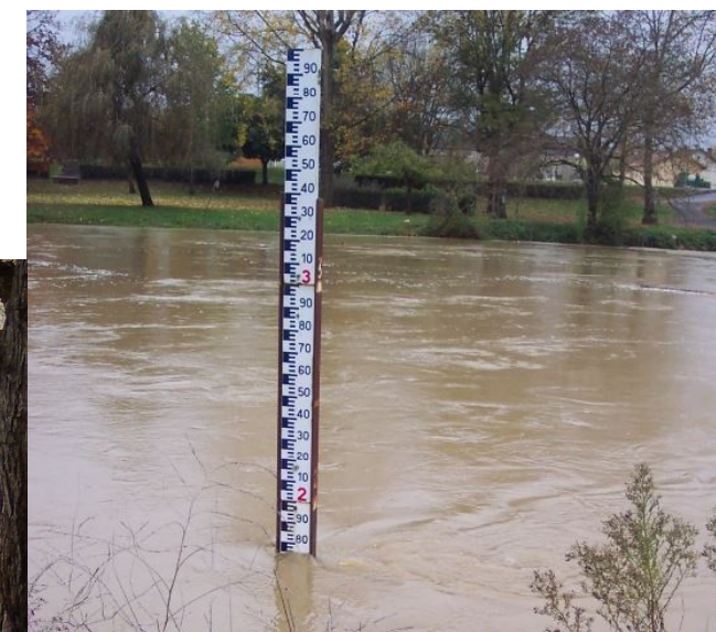
Echelle limnimétrique de Riscle
