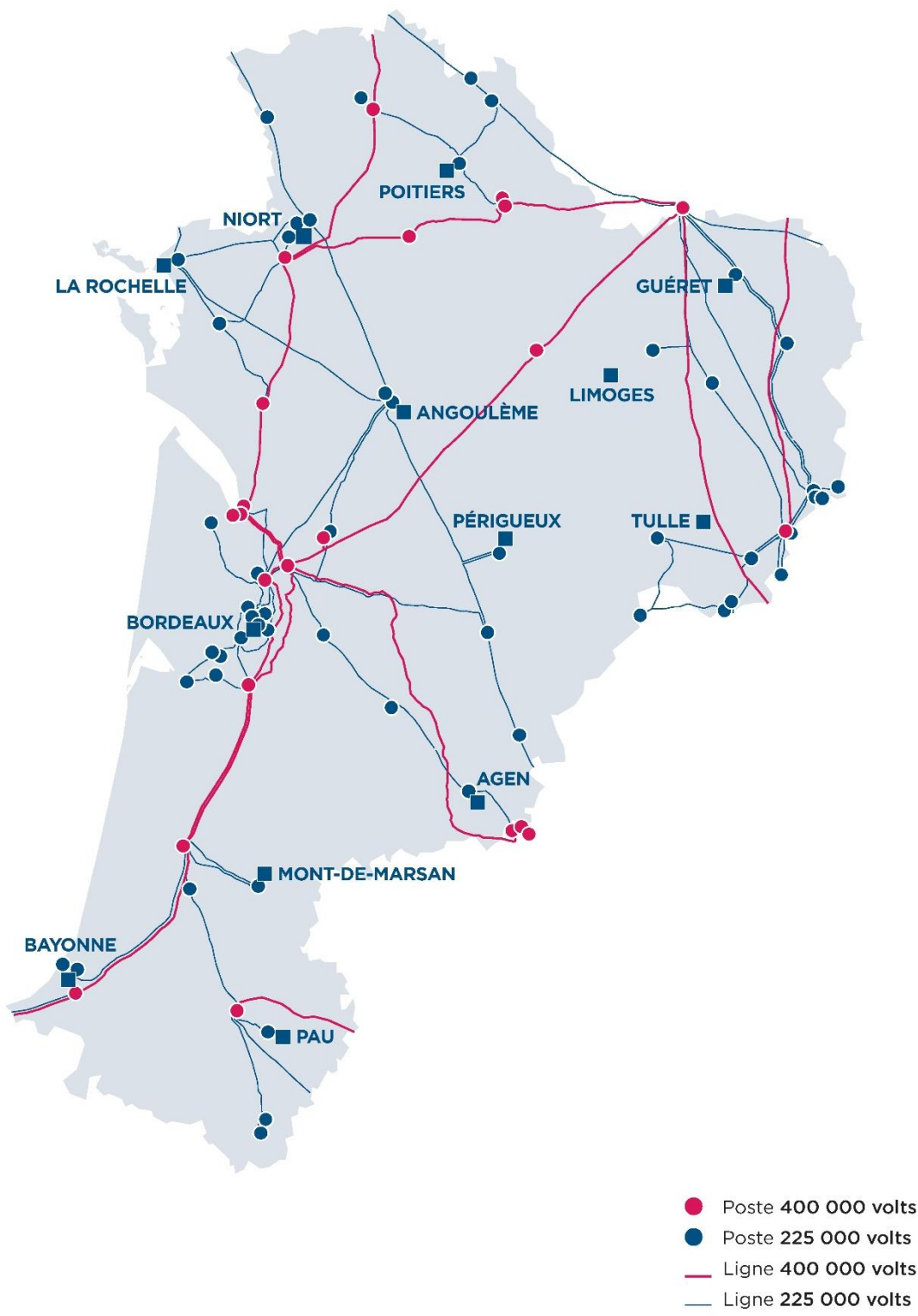
Figure 2 - Carte du réseau 400 et 225 kV en Nouvelle-Aquitaine
