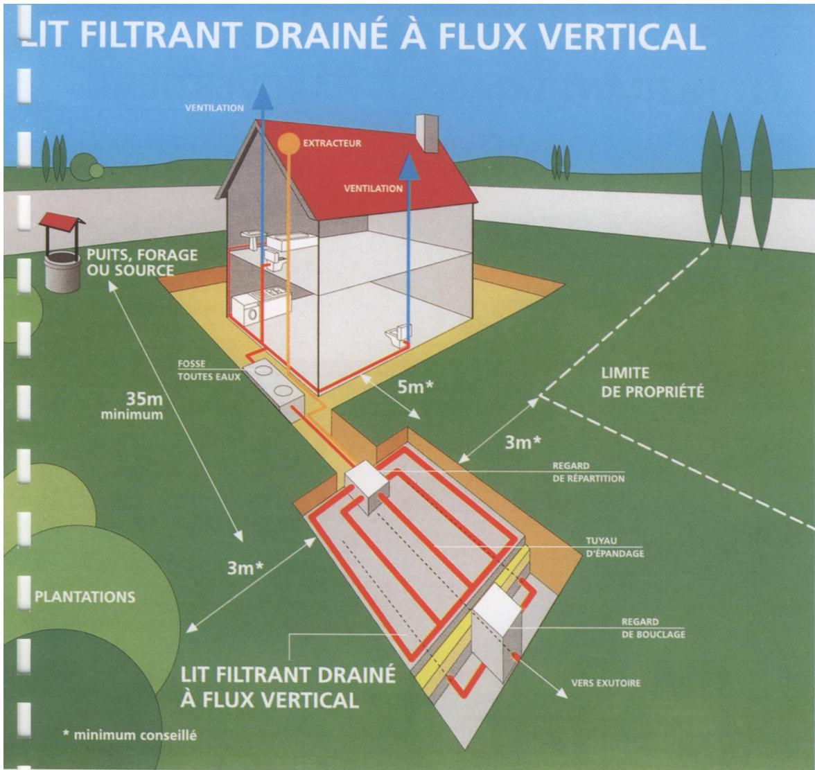
Ce dispositif est à prévoir lorsque le sol est inapte à un épandage naturel et lorsqu'il existe un exutoire pouvant recevoir l'effluent traité.
