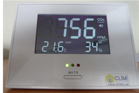
Paramétré pour une utilisation en **Espaces Recevant du Public (ERP)**, le **moniteur pédagogique de mesure** surveille en temps réel **la qualité de l'air intérieur**. Il indique quand la concentration en **CO<sub>2</sub> dépasse un seuil défini** et donne l'alerte par un signal sonore pour **avertir qu'il faut aérer**.
