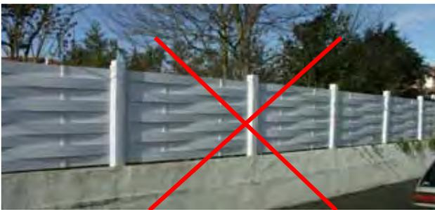
*Des matériaux comme le PVC ou les planches posées tressées sont incompatibles avec un ensemble traditionnel :
