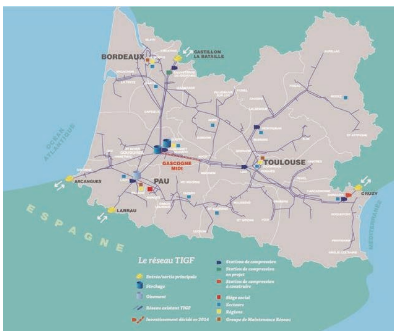
Figure 1 : Le réseau de transport de gaz naturel de TIGF
