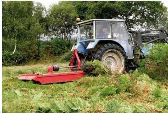
Broyeur à axe vertical
