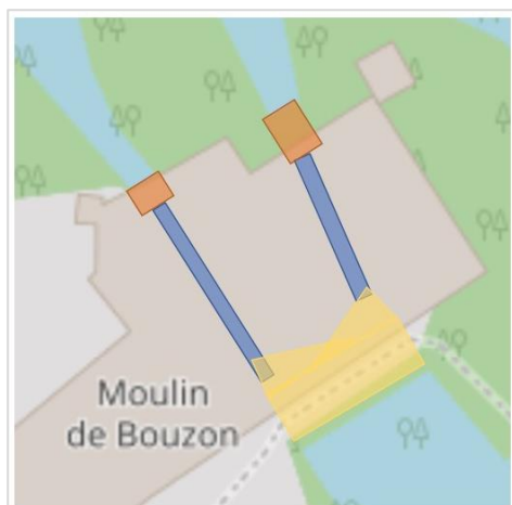
Figure 3. Schéma des canaux usiniers du moulin de Bouzon (En jaune : partie large amont ; en bleu : canaux étroits ; en orange : sortie moyenne avec gîtes potentiels).
